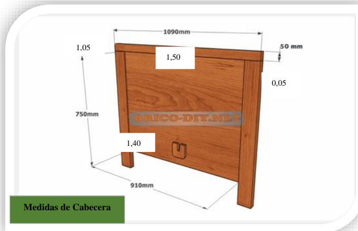
Figura 11 Medidas de la cabecera de una cama
