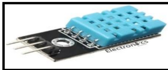
Imagen: Sensor de humedad relativa y temperatura
