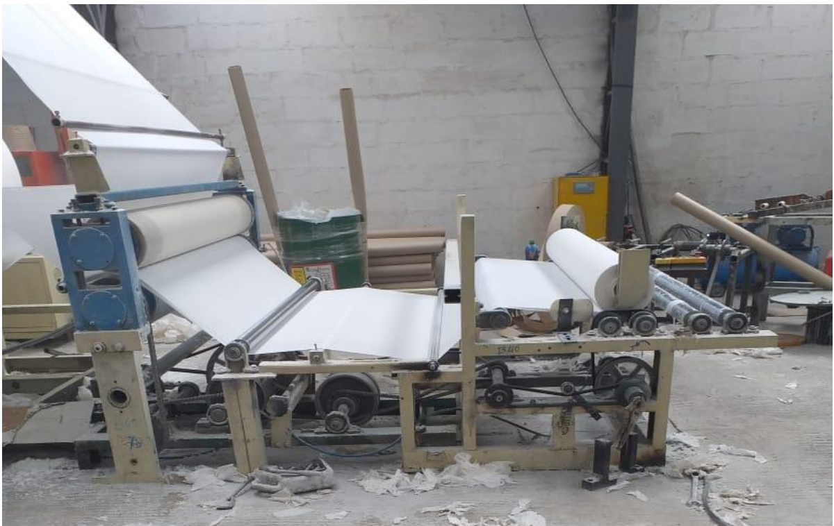
Proceso de rebobinado del papel higiénico en los bastones de Kraft.
