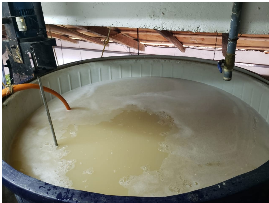
Fotografía 2 Tanque elevado de 1 000 lts. para mezcla de fungicidas en la sala de postcosecha
