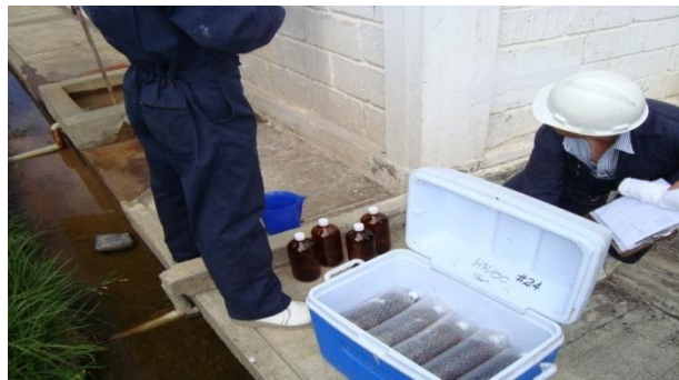
Fotografía # 7 de la toma de muestra del sitio de descarga del caldero DISTRAL.
