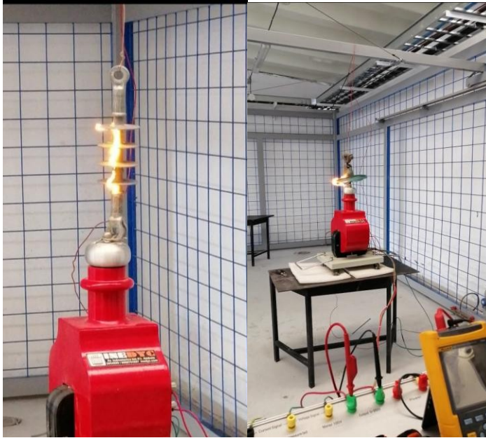
Figura 24: Flashover en aisladores.
