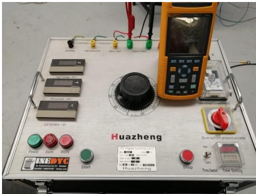
Figura 16. HI-POT Huazheng, de 50kV y 5kVA.
