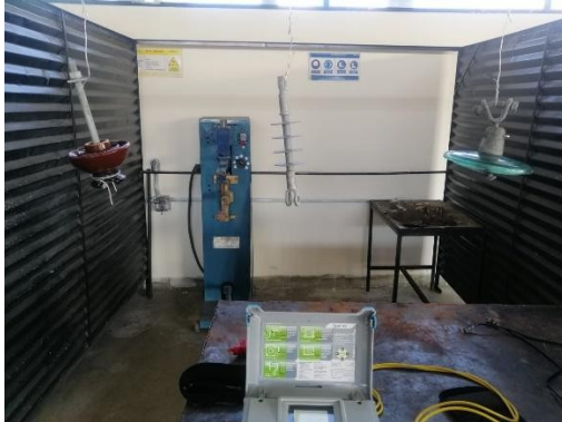
Figura 23: Determinación de la resistencia de aislamiento.
