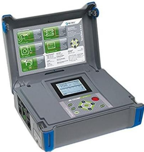
Figura 22: Comprobador de aislamiento Metrel MI3201
