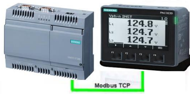
Figura 2.8: Comunicación MODBUS TCP/IP Sentron PAC3220
