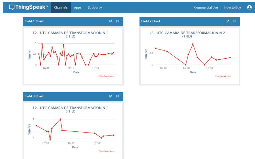
Figura 3.14: Resultados de las distorsiones armónicas THD de la cámara de transformación N°2
