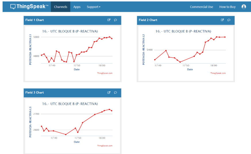
Figura 3.19: Resultados de las potencias reactivas del Bloque B
