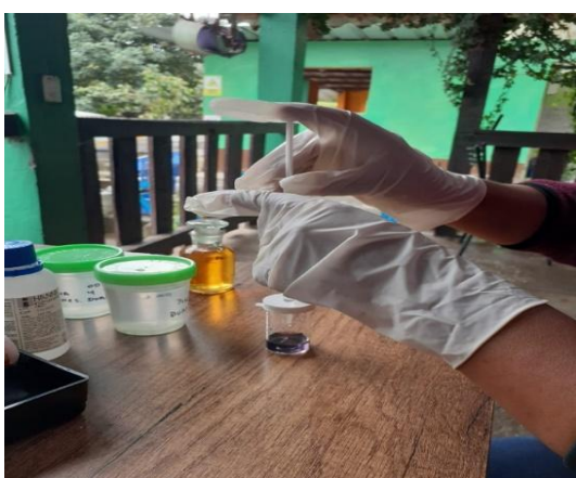
Fotografía 5. Determinación de OD por el método de colorimetría (Winkler).
