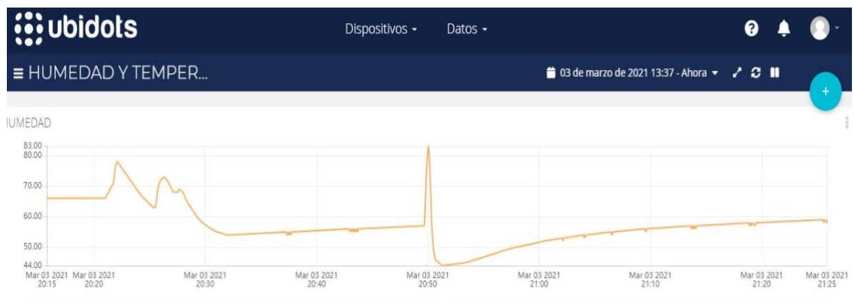
Figura 5.36. Variación de la humedad en la plataforma Ubidots
