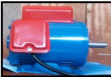
Figura 4.2. Motor monofásico
