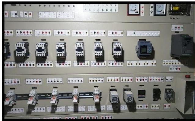
**Figura 4.9.** Colocación de los Jack banana
