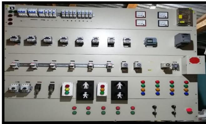
**Figura 4.8.** Implementación de los elementos según el diseño del módulo experimental
