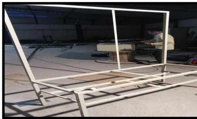
**Figura 4.7.** Estructura del módulo experimental después del proceso de pintura al horno
