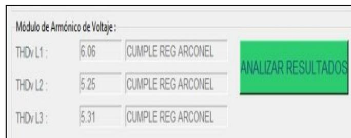
**Figura 28.** Comprobación de distorsión armónica total de voltaje por cada línea.
