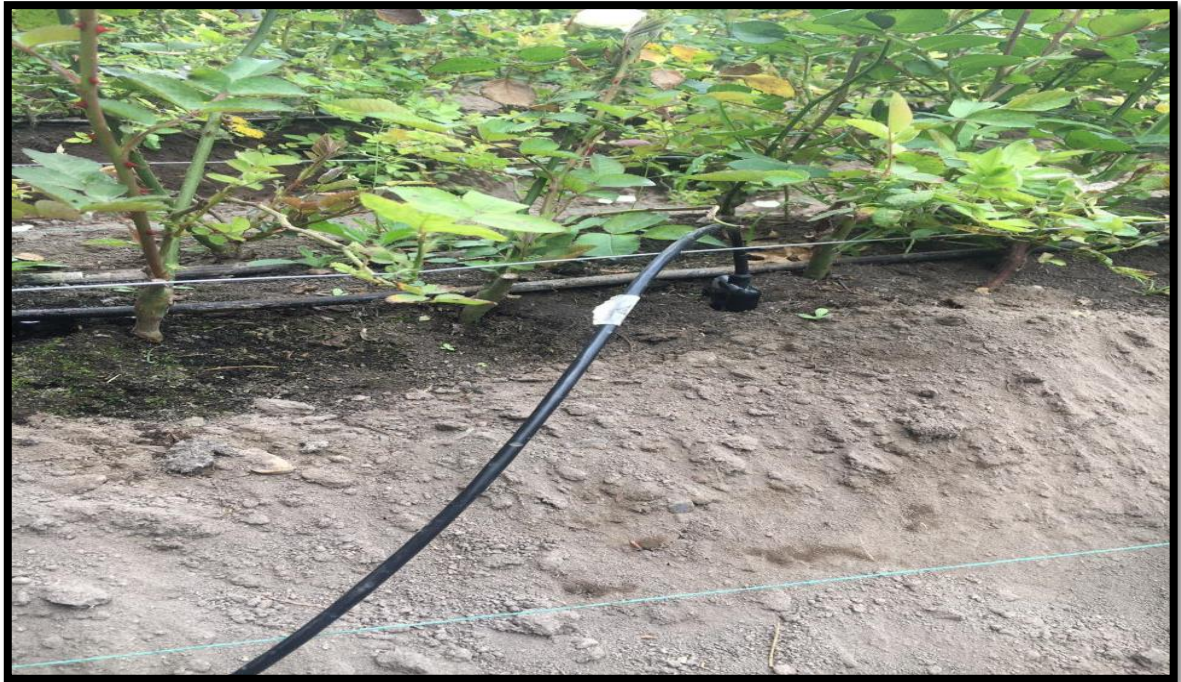
Figura XIX.1: Ubicación de sensores de humedad
