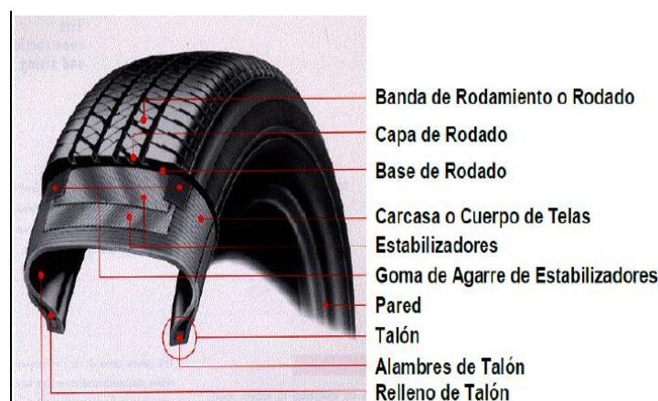
Ilustración 5: Partes de un neumático
