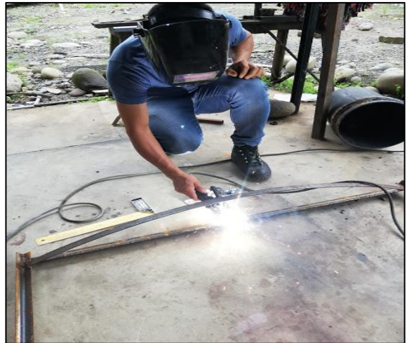
Fotografía 3: Chumacera y eje para en de la base reflectora Fotografía 4: Suelda del eje a la base reflectora
