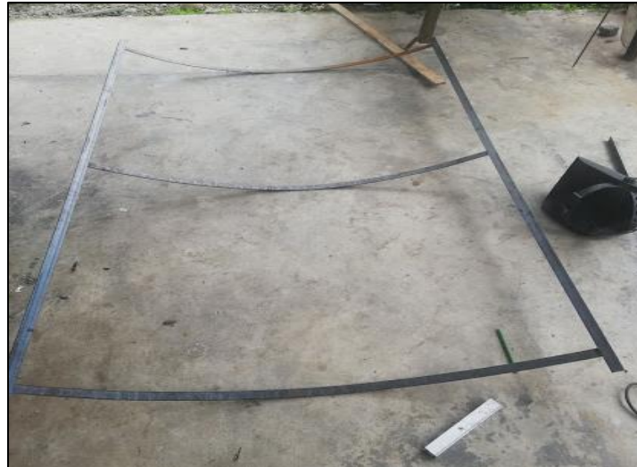
Figura 22: Estructura de la base reflectora
