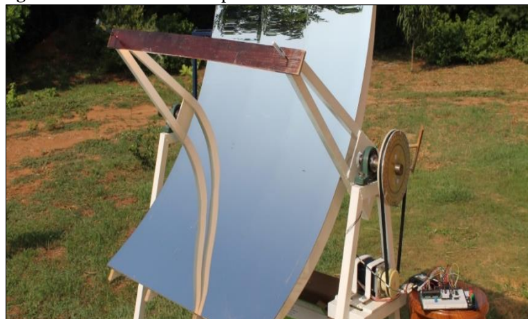
Figura 7: Colector cilíndrico parabólico
