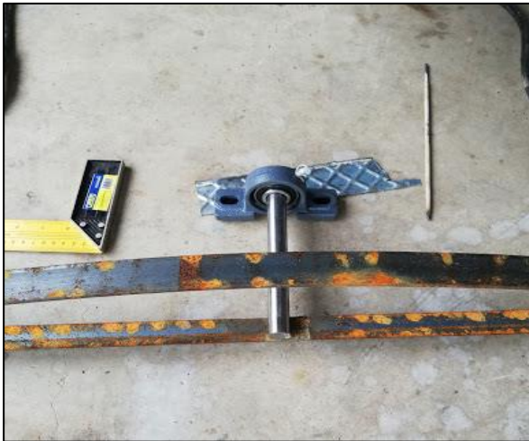
Fotografía 3: Chumacera y eje para en de la base reflectora Fotografía 4: Suelda del eje a la base reflectora
