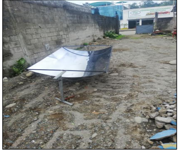
Fotografía 2: Base reflectora de acero inoxidable
