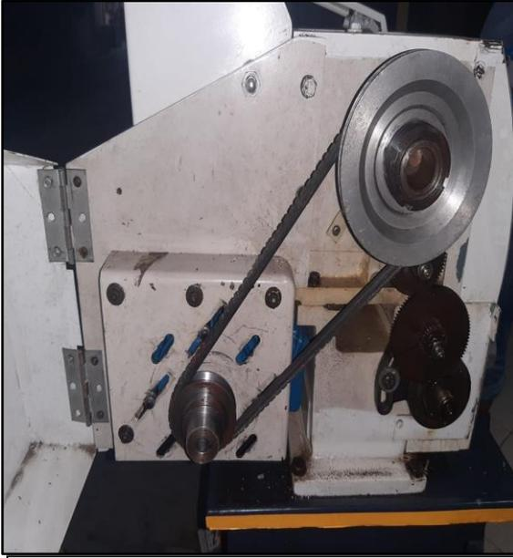
**Figura 23:** Puesta de motor y de polea para que funcione con el mecanismo
