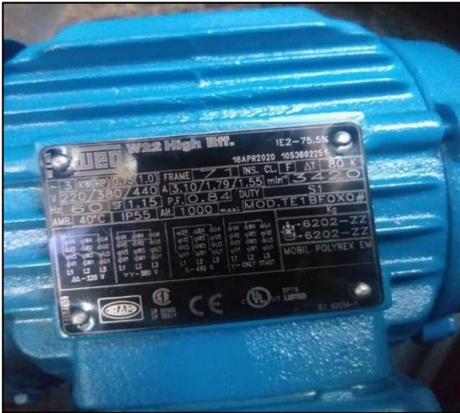
**Figura 19:** Placa característica del nuevo motor
