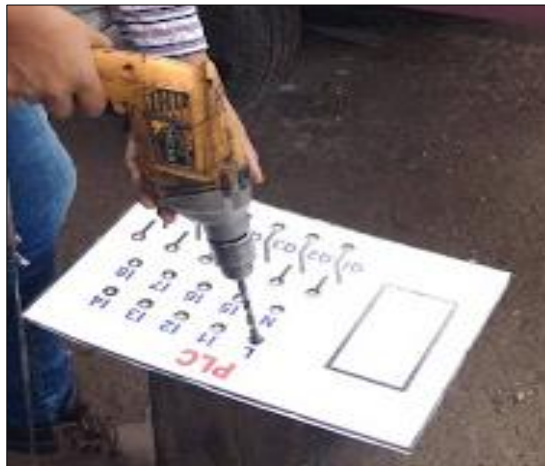
Figura 16: Perforación de láminas con taladro
