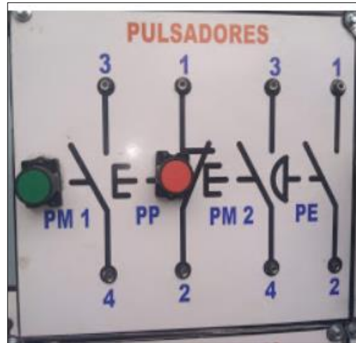
Figura 21: Lámina de conexión para los pulsadores[ADPA10]
