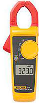
Figura 4.9. Pinza amperimétrica Fluke323 [29].
