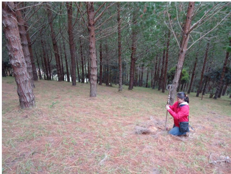
FOTO N° 2: Calibrando el hipsómetro de Merrit para determinar la altura del bosque
