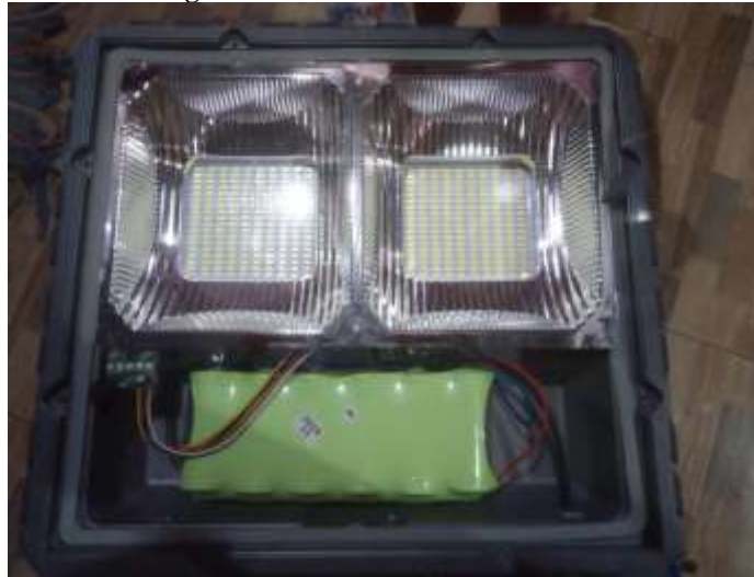
Figura 8: Reflectores fotovoltaico DC
