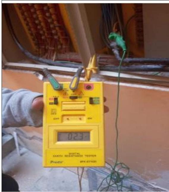
Figura 6. Telurómetro utilizado
