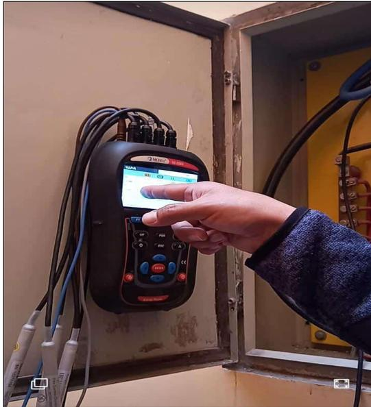
Figura 5. Analizador de redes utilizado
