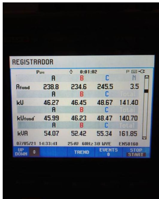
(a) Parámetros de potencia de la L1, L2, L3 y N de medición del analizador trifásico de energía y calidad de la energía eléctrica FLUKE 435 - II.
