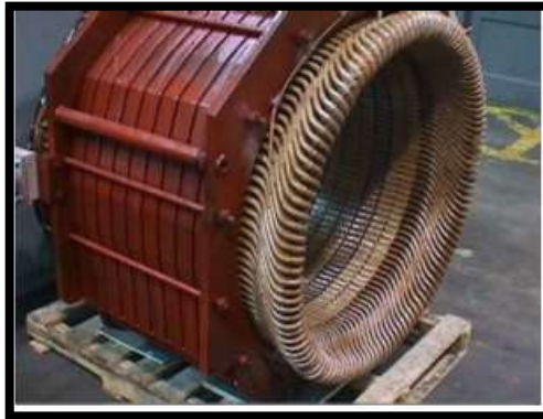
Figura 8. Estator de un generador síncrono.
