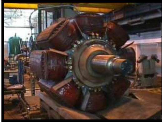
Figura 7. Rotor de un generador síncrono
