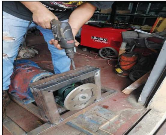
Anexo 9: Realizando perforaciones para colocar las chumaceras
