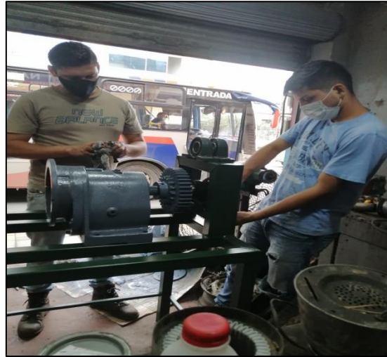
Anexo 15: Ensamblaje del motor y engranajes
