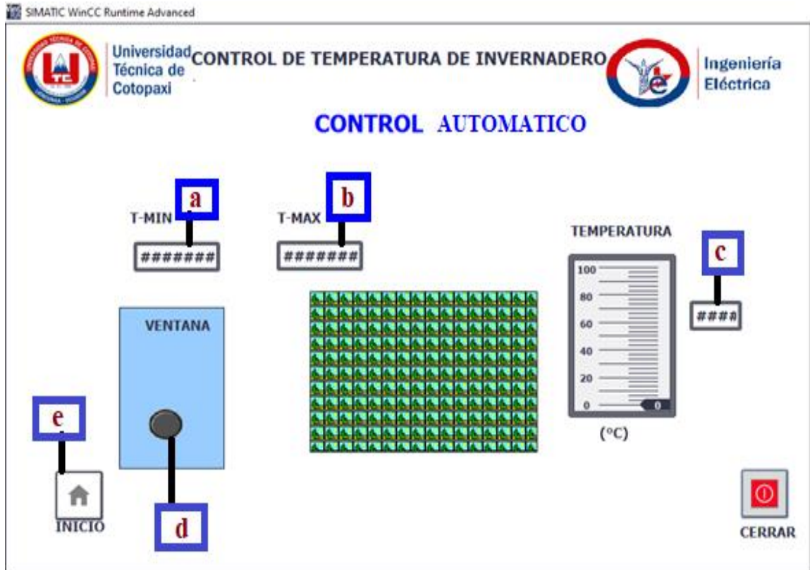
Imagen 13 Pantalla del control automático de temperatura
