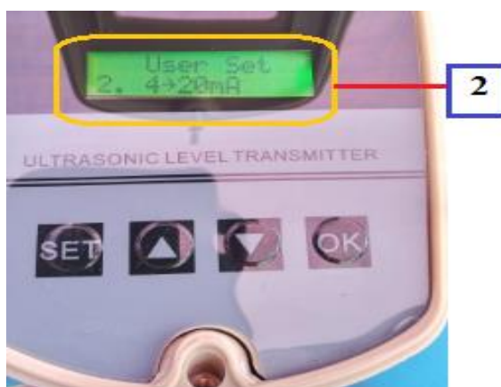
Imagen 4 Configuración de la señal de corriente 4-20mA.
