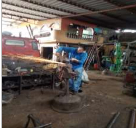
Figura 39 Fabricación del eje para el acople al sistema removedor por paletas.
