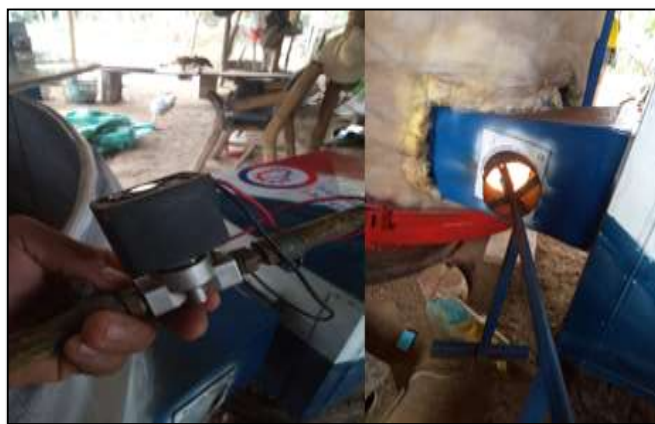
Figura 59 Sistema de encendido automatizado
