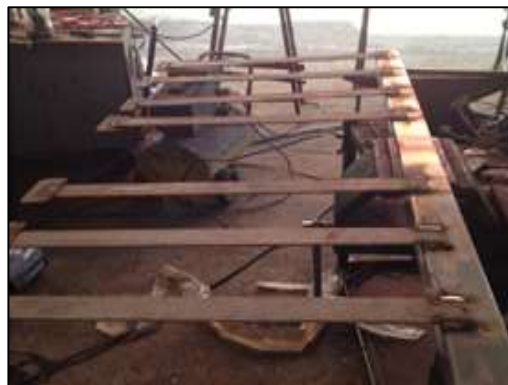
Figura 38 Fabricación de las paletas para el sistema removedor.
