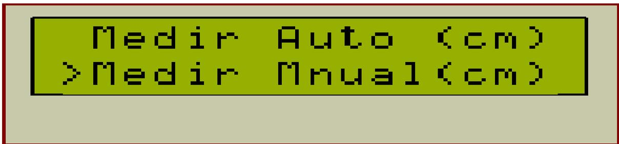
En esta opción se realiza el mismo procedimiento que en la primera, con la diferencia que la altura del tanque se debe introducir de forma manual usando los números del display y después presionando la tecla **#**. Ya configurados los parámetros se debe salir del menú de calibración, esto se realiza presionando la tecla **C**. Se muestra en el display el modo en que se encuentra el sistema (Modo Manual) y el porcentaje de llenado. Ver figura 36.
