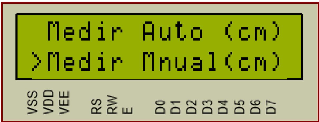
En esta opción se realiza el mismo procedimiento que en la primera, con la diferencia que la altura del tanque se debe introducir de forma manual usando los números del display y después presionando la tecla **#**. Ya configurado el parámetro se debe salir del menú de calibración, esto se realiza presionando la tecla **C**. Seguido se muestra en el display el modo en que se encuentra el sistema (Modo Manual) y el porcentaje de llenado. Ver figura 51.
