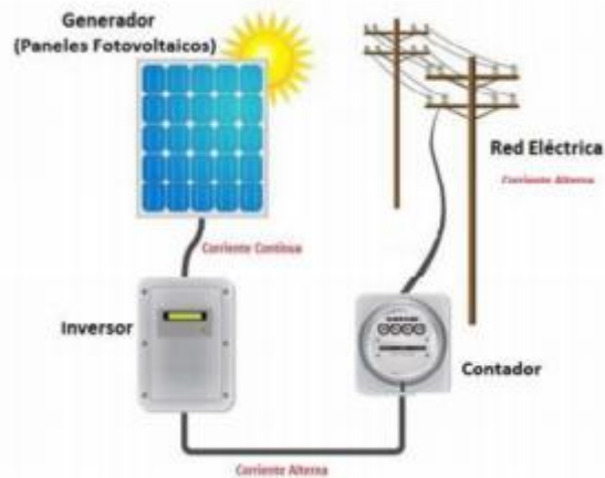
Figura 3.8. Sistema solar fotovoltaico conectado a la red [37].
