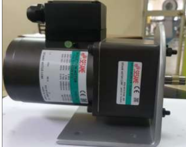
Fotografía 6: Motorreductor y base
