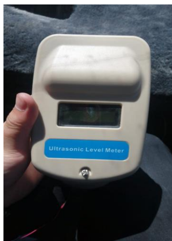
Figura 5.2 Vista Frontal del Sensor Ultrasónico Huandian HDL700-A1.
