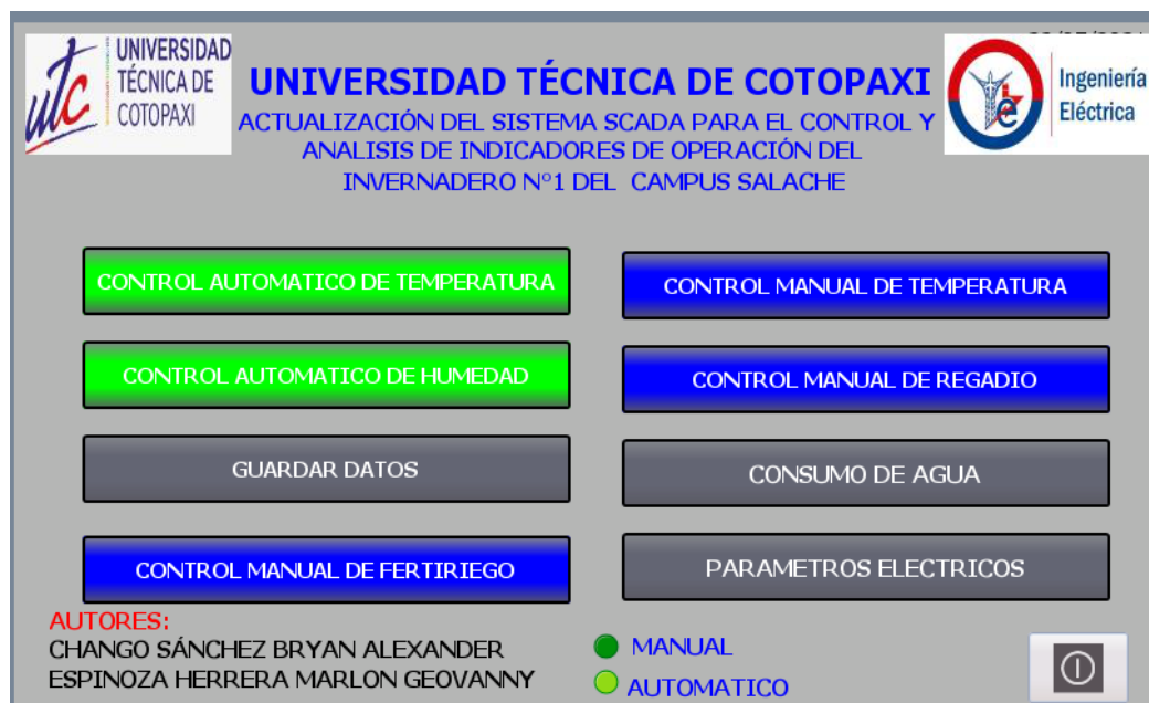
Figura 5.19 Pantalla del sistema SCADA.
