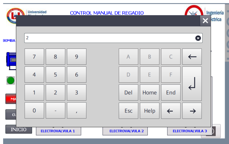
Figura 16. Ingreso de tiempo para control manual
