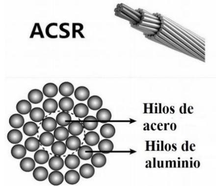
Figura 3 Conductor ACSR [25].
