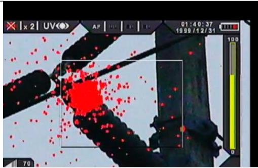
Figura 17 (a) Efecto corona en el aislador
