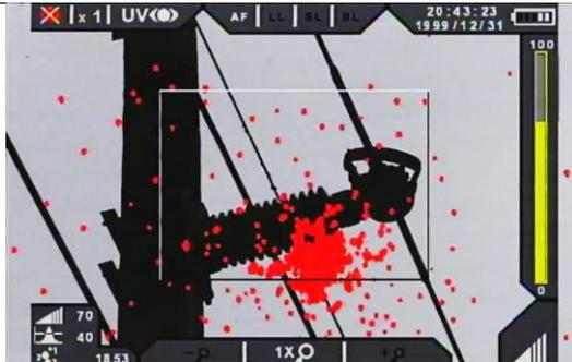
Figura 17 (c) Efecto corona en el aislador
