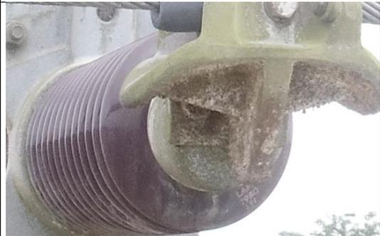
Figura 17 (d) Anomalia en aislador
