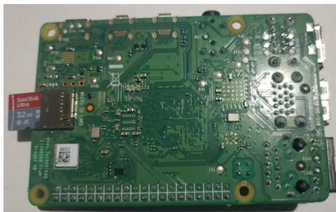
Figura 4.4. Inserción de la tarjeta micro SD en la tarjeta de desarrollo.
