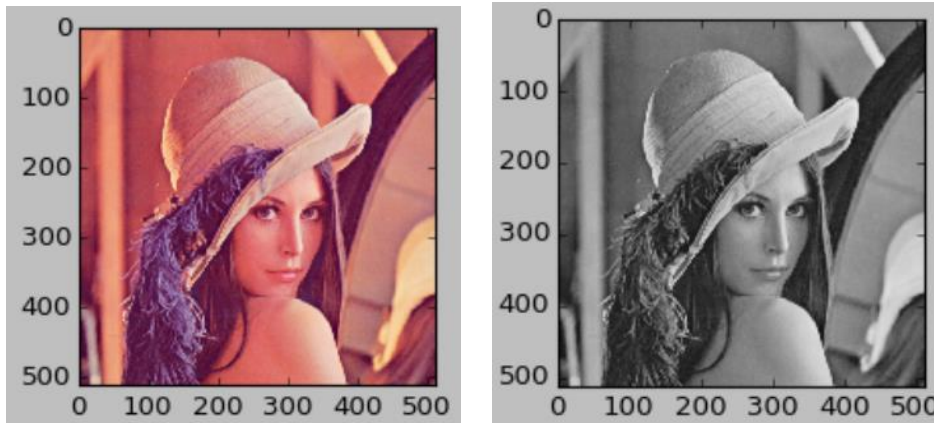
Figura 4.18. Transformación de una imagen a escala de grises.
