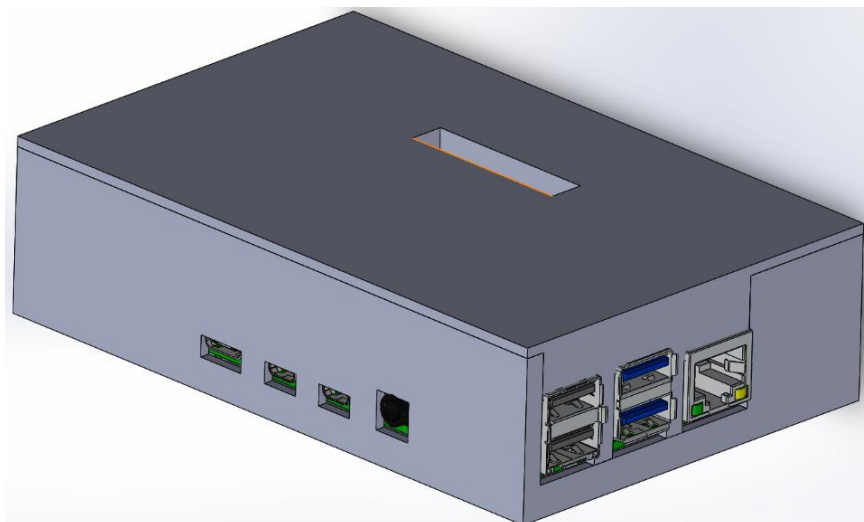
Figura 4.32. Diseño de la carcasa donde se aloja la tarjeta Raspberry.
