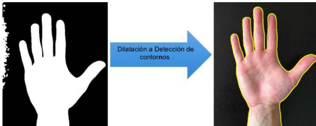
Figura 3.4. Proceso de dilatación al proceso de detección de contornos.
