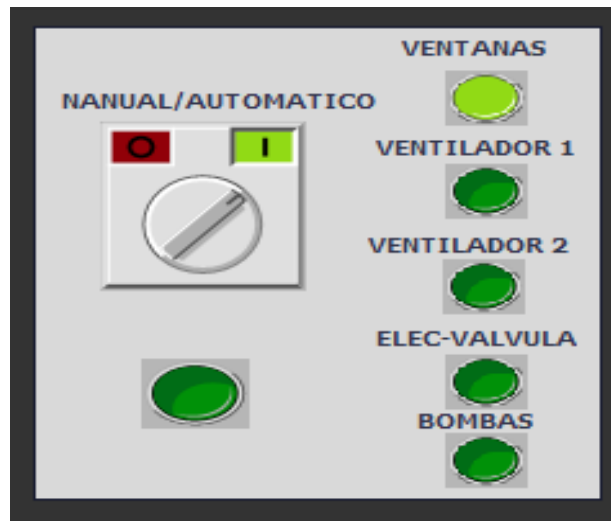
Figura 11.27: Selector de funcionamiento del invernadero
