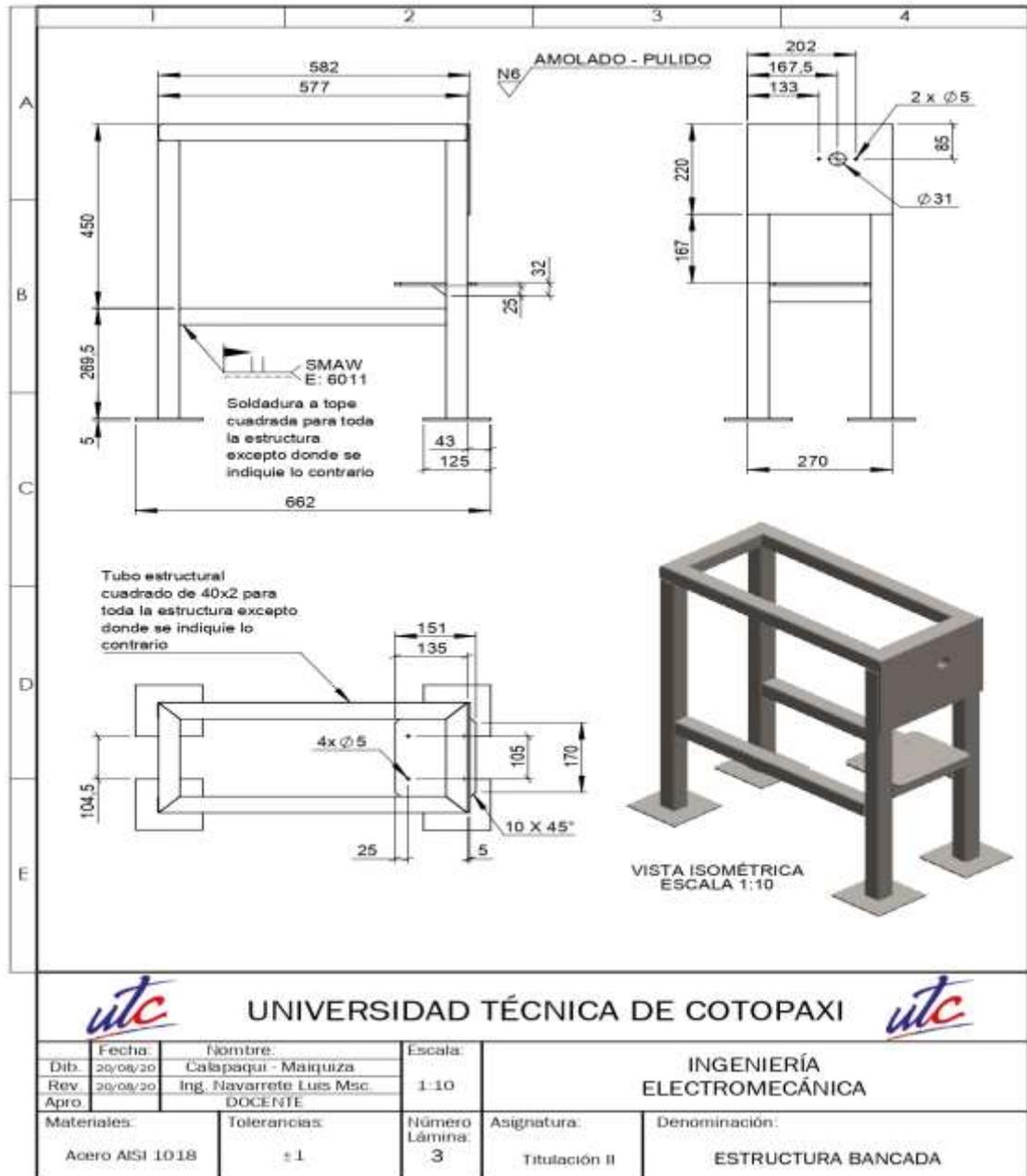
**Figura 4. 9 Plano estructura bancada**
