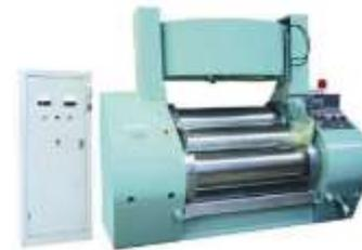
**Figura 2. 6.** Molino de rodillos trituradores
