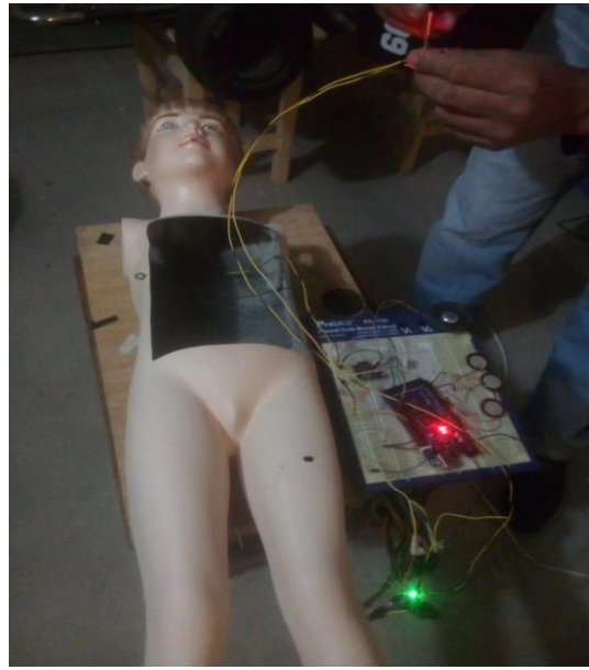
Colocación de sensores en el maniquí con el protoboard.
