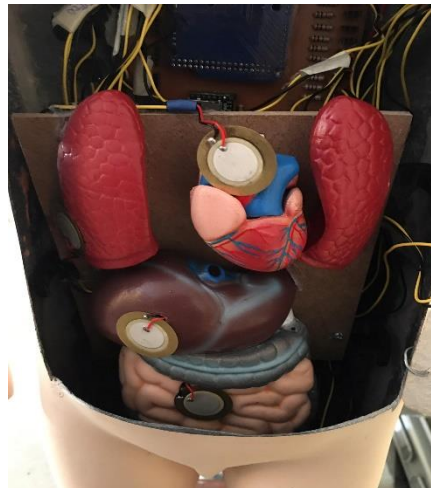
Conexión del cableado a la baquelita de las partes internas del maniquí.
