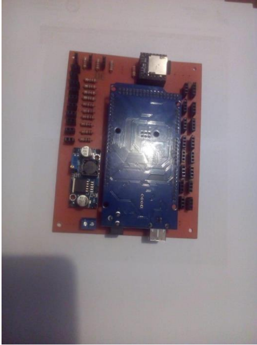
Conexión del arduino con el mp3 en la baquelita.
