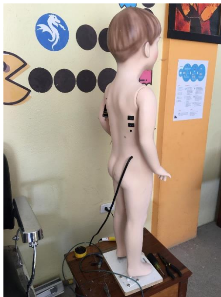
Culminación de la parte trasera del maniquí con su conector de fuente y pulsador de encendido y apagado con el cambio de idioma.
