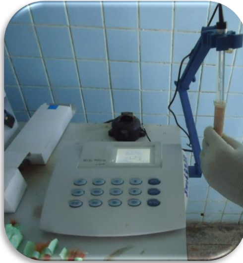
Imagen 16. Medición del pH del intestino delgado y del ciego
