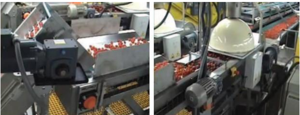
Figura 3-13. Máquina clasificadora con redes neuronales
