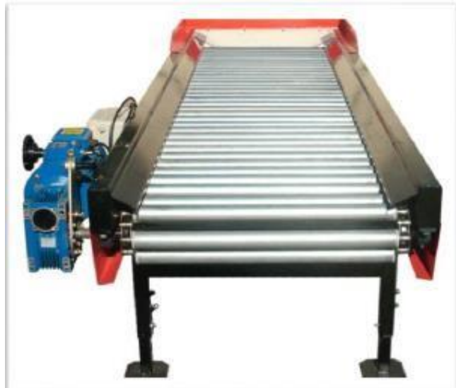
Figura 3-18. Máquina clasificadora con rodillos
