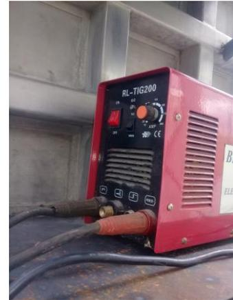
**Fig.2:** suelda para inducción de corriente a las celdas.
