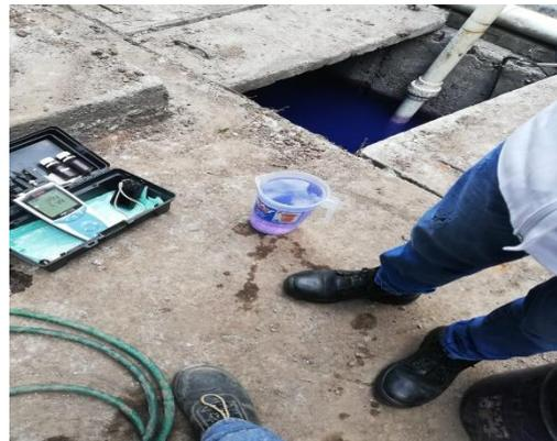
**Fig.4:** Pruebas de jarras y medición de pH.
