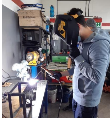
Construcción del sistema de poleas
