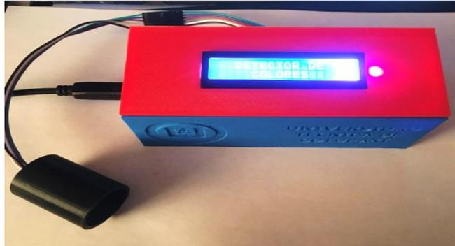
**Figura 5. 4** Dispositivo identificador de colores.
