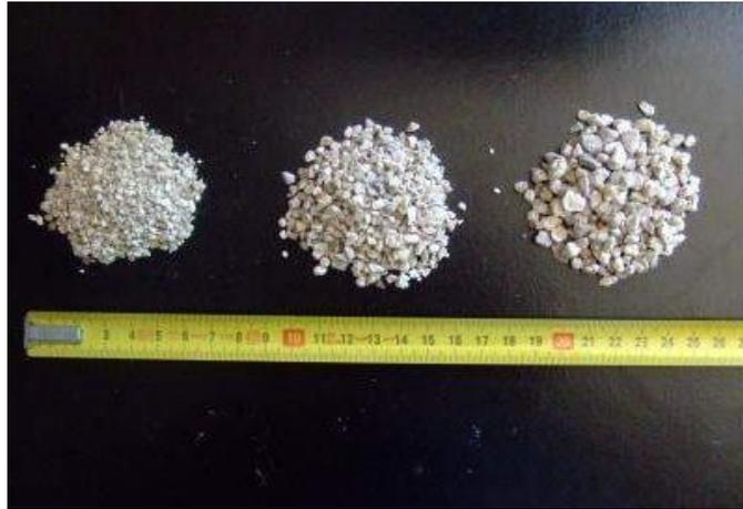
Figura 3.3. Medición Granulometría
