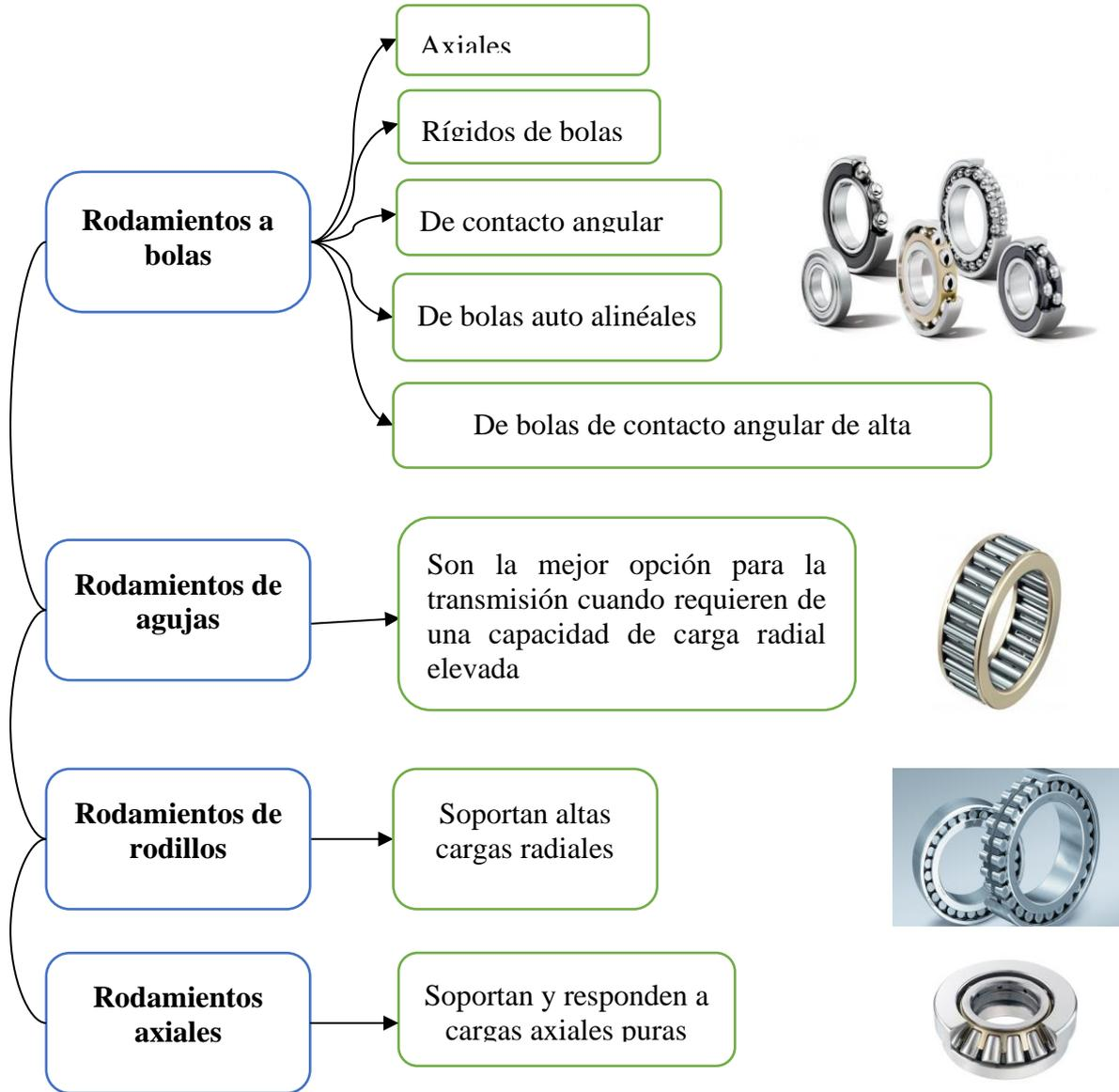
Figura 3.18. Clasificación rodamientos
