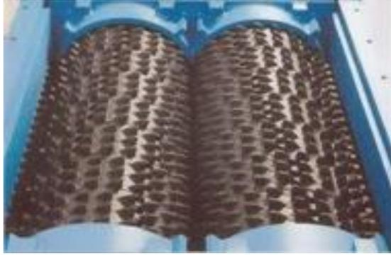
Figura 3.7. Trituradora de cilindros dentados
