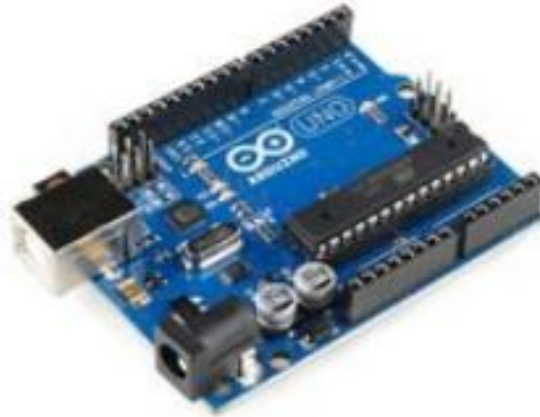
Figura 3.4. Microcontrolador Arduino uno.
