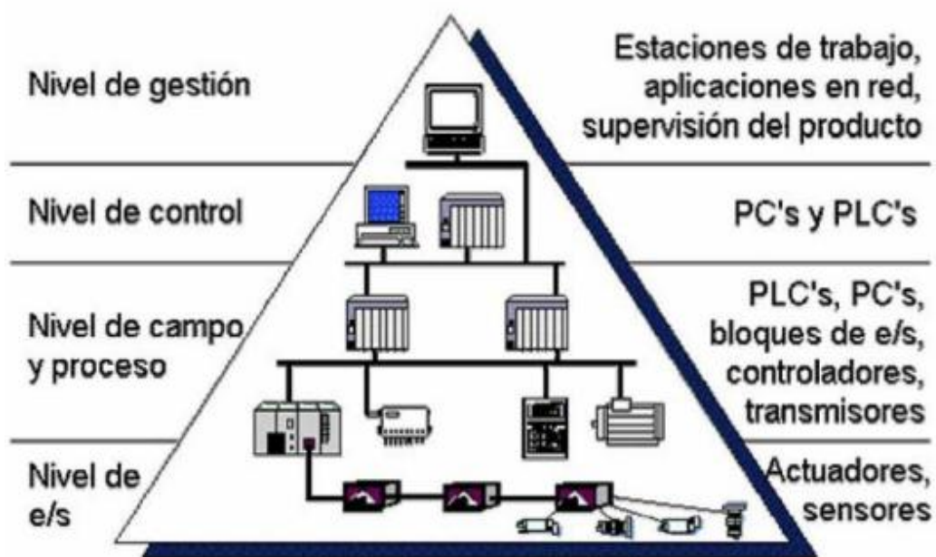
Figura 3.15. Pirámide de automatización.
