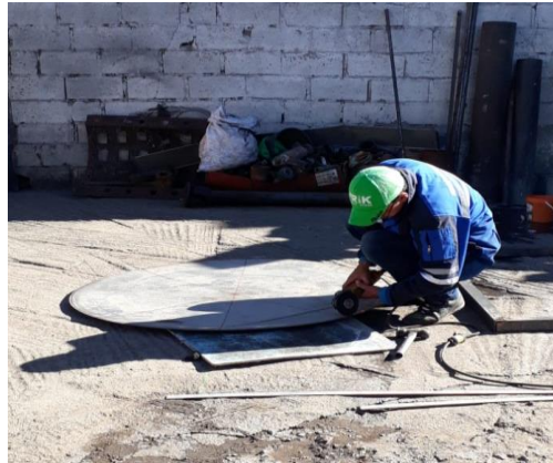
Figura 9. Corte de la bandeja redonda
