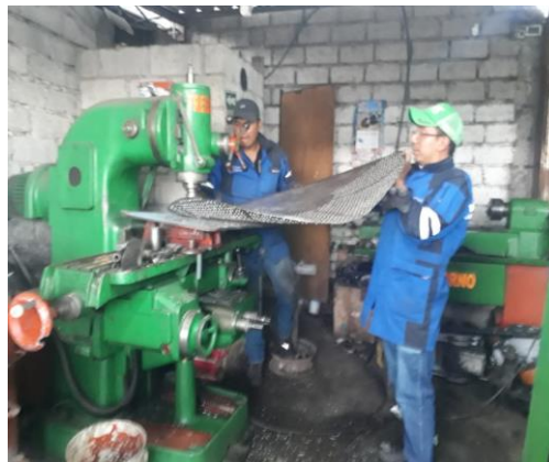
Figura 10. Ensanchamiento de los orificios
