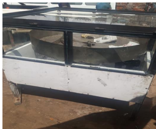
Figura 12. Montaje del contenedor en la máquina
