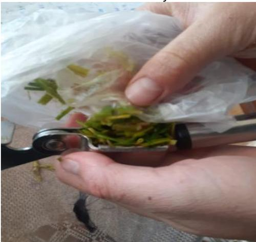
*Sacar el sumo del material vegetal y colocarlo en el electrodo*
