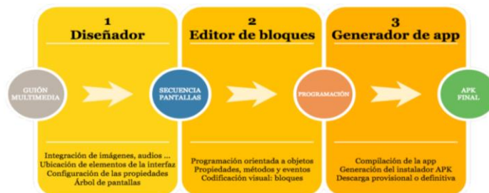
Figura 3.9. Proceso de creación de una app con MIT App Inventor
