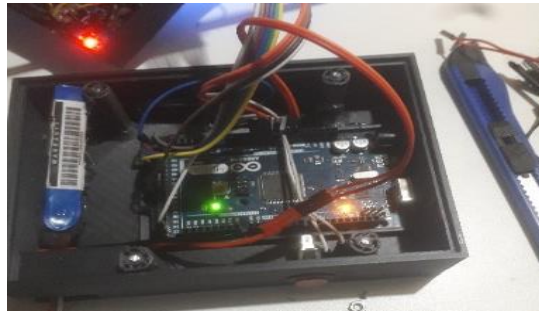
Figura 4.8. Ensamble del circuito en la carcasa.
