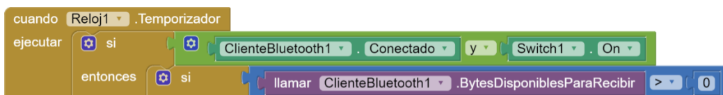
Figura II.8. Subrutina para determinar las condiciones necesarias para iniciar el análisis.
