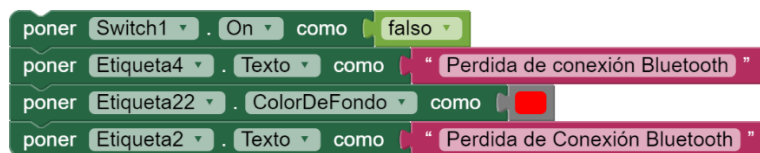
Figura II.16. Subrutina para enviar el mensaje correspondiente en caso de que el dispositivo pierda su conexión.
