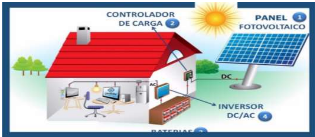
Figura 3. 11. Sistema de Acumulación de Corriente directa y alterna (CC/CA)
