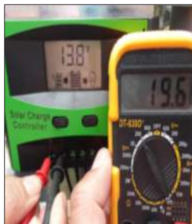
Figura 5. 20. Valores a la salida del panel y del controlador
