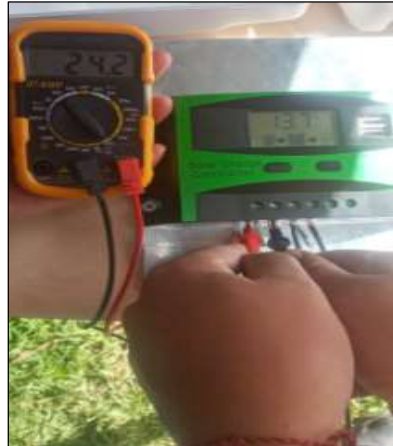
Figura 5. 19. Valores a la salida del panel y del controlador
