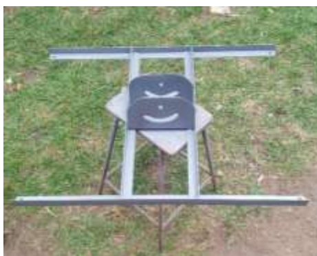
Figura 5. 14. Estructura para la inclinación del panel solar
