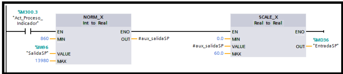
Figura 1.4. Escalamiento de señales analógicas (SP).
