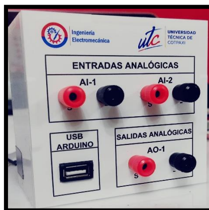
Figura 4.16. Tablero de Interconexión.
