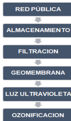
Gráfico 10 Proceso de purificación Elaborado por: Edwin Porras
