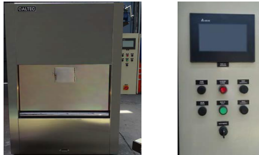
Ilustración 10 Horno crematorio - puerta principal y panel de control
