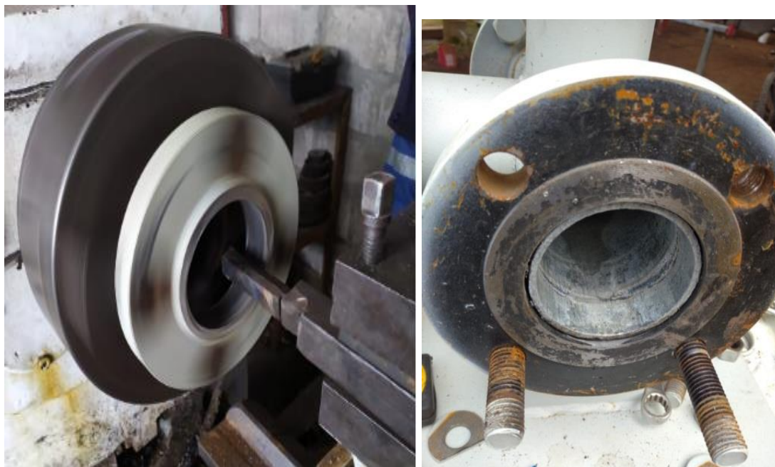
Figura 5. 1. Brida de la bomba de ariete.
