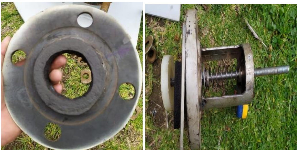
Figura 5. 6. Entrada de brida modificada.
