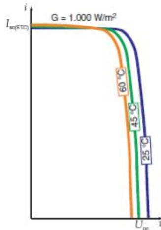
**Figura 3.15.** Características de célula solar en función de la temperatura de la célula [21].
