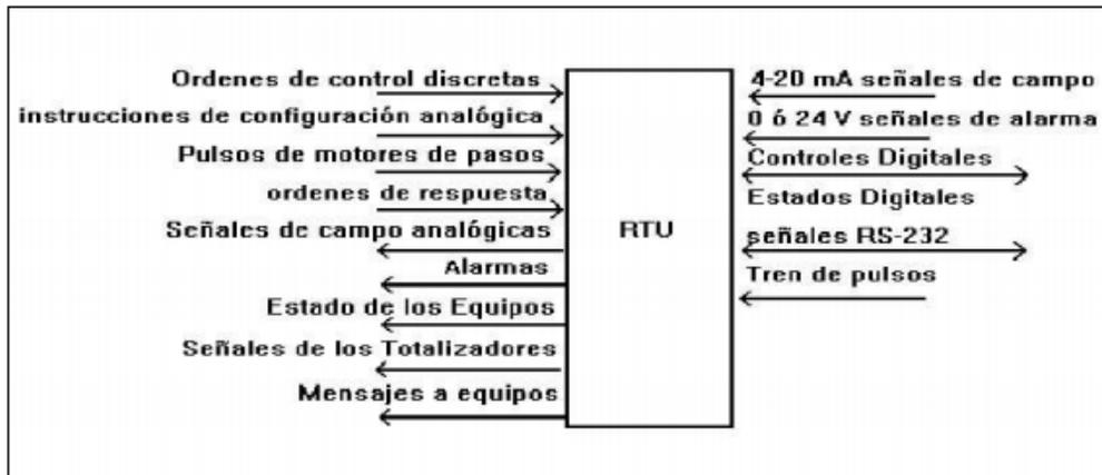
**Figura 3.8.** Funciones Básicas de una RTU en sistemas SCADA (Relación E/S) [18].
